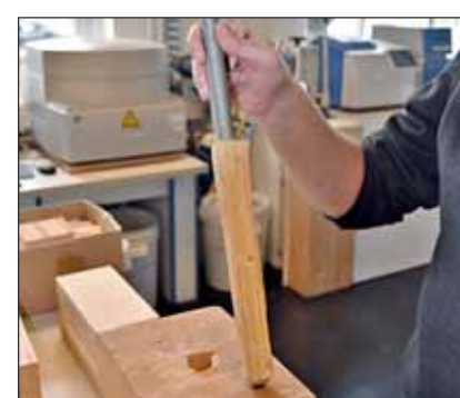
Der Stahlbauteil ist so gut verklebt, dass eher das ihn umgebende Holz reißt, als dass sich der Stahl vom Holz löst.
