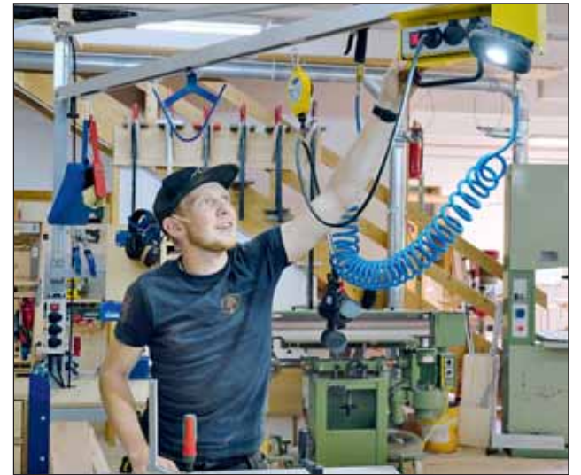
Die Arbeitsbeleuchtung haben die Kitzbüheler Werkstätten selbst ergänzt und zeigen damit, wie gut sich Auslegerarm und „Orga Car“ an individuelle Bedürfnisse anpassen lassen.
