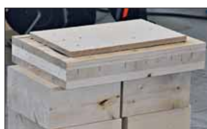
Modellhafte Aufleimung einer Verstärkung mit Verschraubung Fotos: Amschl
